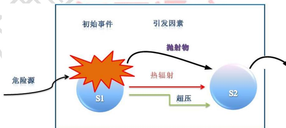
F 图 2.5-1 多米诺效应系统图
