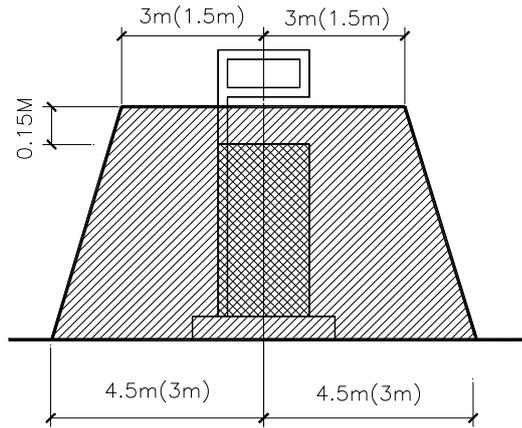
注：采用加油油气回收系统的加油机爆炸危险区域用括号内数字。
