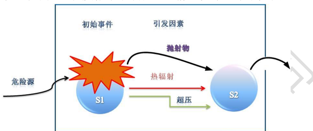
图 4.4-2 多米诺效应系统图
